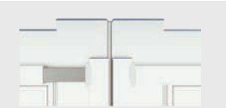
1 - Cadre inox soudé sur 4 faces recouvert d'un gainage blanc avec clé de gainage
